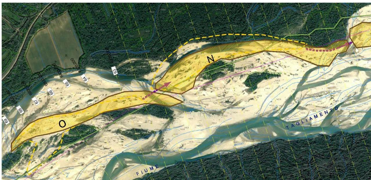
**Figura 32:** le aree di scavo previste nell'alternativa. L'ortofoto nello sfondo rappresenta la situazione dell'alveo nell'anno 2002.
