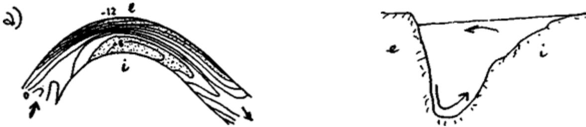
Erosione in prossimità di una curva: a) pianta; b) sezione trasversale.
