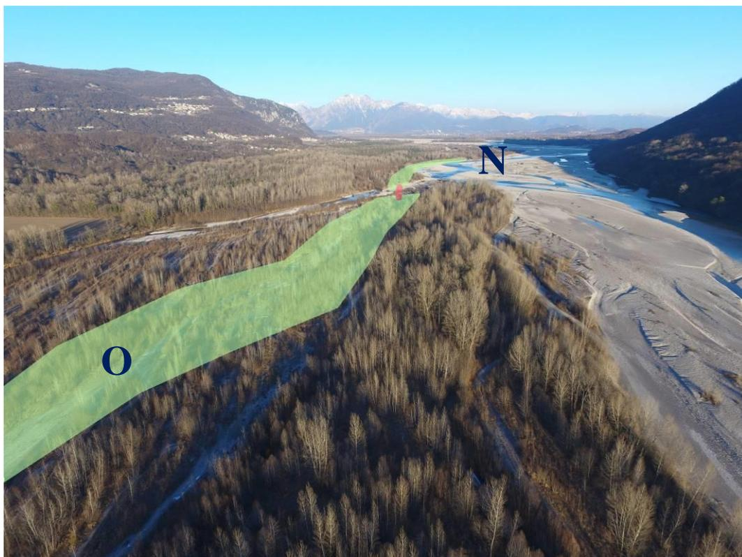
**Figura 9:** individuazione dell'area di scavo "O" come prevista nell'alternativa al fine di minimizzare le superfici caratterizzate da arbusteti (V. PARAGRAFO 5.2).
